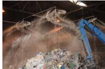
gleichmäßige, flächendeckende Beschäumung von Schüttgut durch Schaumausbringung mit Rotoren
